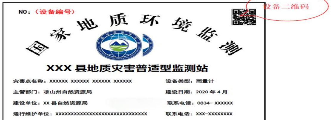
图 5.10-1 监测设备铭牌结构图
