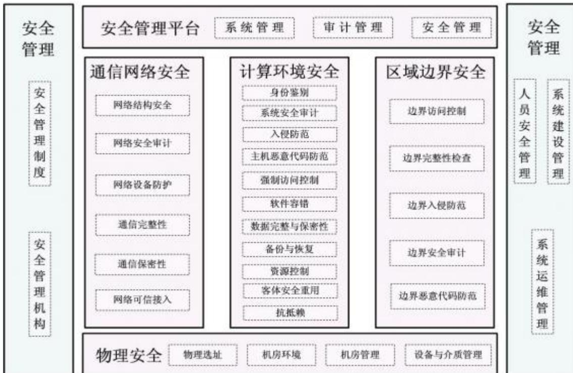
图 4 安全防护逻辑架构图
